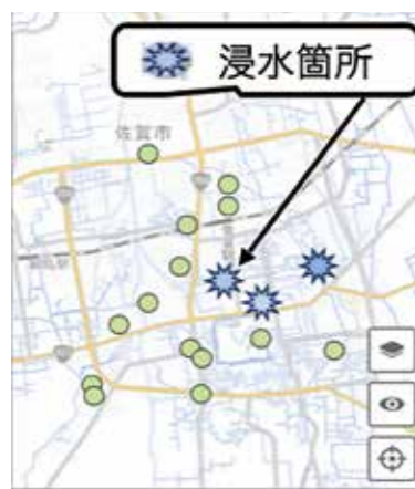
大雨時に浸水深を自動計測する標尺。このデータが地図上に表示される = 佐賀市駅前中央の新家公園
