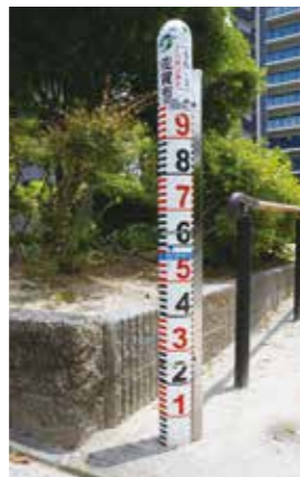
大雨時に浸水深を自動計測する標尺。このデータが地図上に表示される = 佐賀市駅前中央の新家公園
